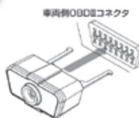
3. OBDロック本体を奥までしっかり挿入した状態で、専用キーでロックします。
