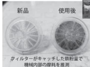
フィルターがキャッチした鉄粉量で機械内部の摩耗を推測
