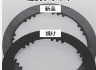
走行を続けているとクラッチにスラッジが付着しジャダー（車体振動）が起こります。クラッチに付着したスラッジを取り除きジャダーの発生を未然に防ぎます。クラッチの摩耗も防止します。
