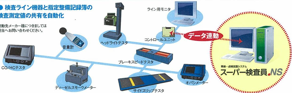
検査ラインとの連動により、検査車の車両情報や測定後の検査数値を、ボタン1つで連動が行え、1台の車両検査・1枚の記録簿作成における、業務をより効率化することが可能
