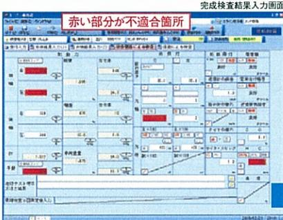
完成検査の項目も、検査機器で測定された検査結果を入力することで、保安基準値に不適合が無いかの確認をシステムで自動チェック
