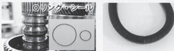
「Oリング」はバルブボディやトルクコンバーター内など油圧を受ける各所に付いており油圧の制御に重要な役割を担っています。「Oリング」の硬化・劣化は変速ショック、さらにはクラッチの摩耗を促進します。硬化しかけている「Oリング」を柔らかくすることで油圧を回復し伝達能力を改善します。
