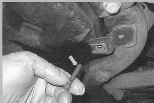
▲オーバーフロープラグ取り外し作業
