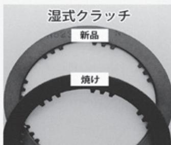
走行を続けているとクラッチにスラッジが付着しジャダー（車体振動）が起こります。クラッチに付着したスラッジを取り除きジャダーの発生を未然に防ぎます。クラッチの摩耗も防止します。
