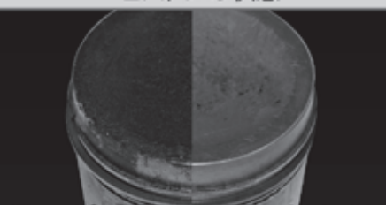
汚れたピストン きれいなピストン
