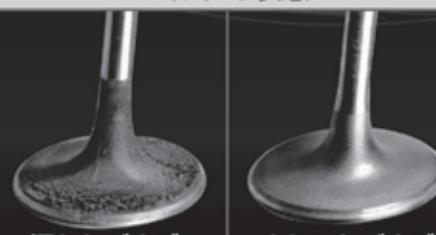
汚れたバルブ きれいなバルブ
