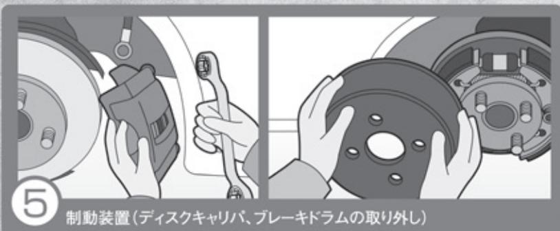
5 制動装置（ディスクキャリパ、ブレーキドラムの取り外し）
