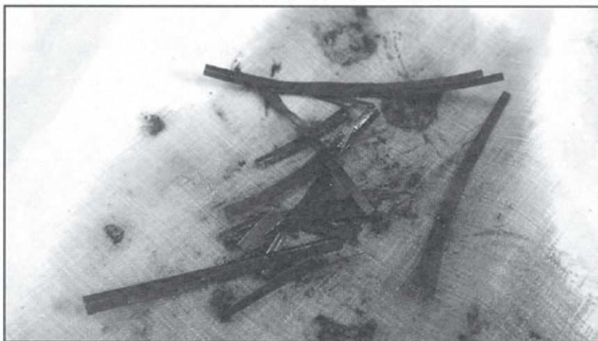
※オイルパンに落ちていたスチール・ベルトの写真
