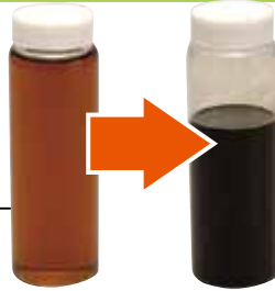
エンジンオイルの汚れ
