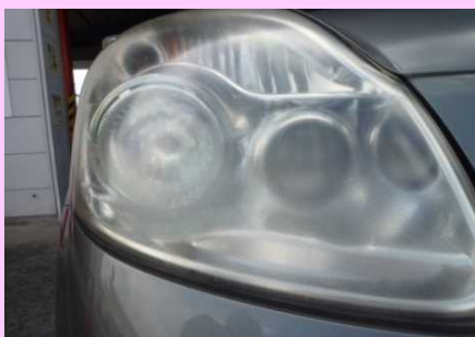
レンズ面の劣化
